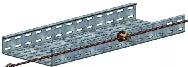
Figure 5. [Exemple de liaison équipotentielle sur CDC]
